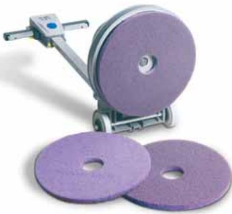
Для повышения блеска мраморных полов используйте фиолетовый круг Scotch-Brite™. Установите круг в машину темной стороной вниз, используйте большое количество нейтрального моющего средства или воды. Пол должен быть сильно намочен. При достижении максимального блеска во влажном состоянии полируйте далее пол фиолетовым кругом всухую для добавочного усиления блеска, используя машину со скоростью до 400 оборотов в минуту.
