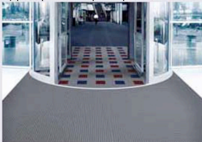
Снаружи - модульное покрытие Nomad 8300, в приемке - модульное покрытие Nomad 8900 с комбинацией красных и синих вставок, внутри - синее покрытие Nomad Aqua 9500.
