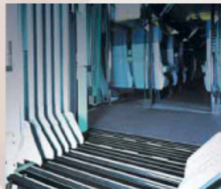
Скоростной поезд, площадка между пассажирскими вагонами (Deutsche Bahn, Германия)
